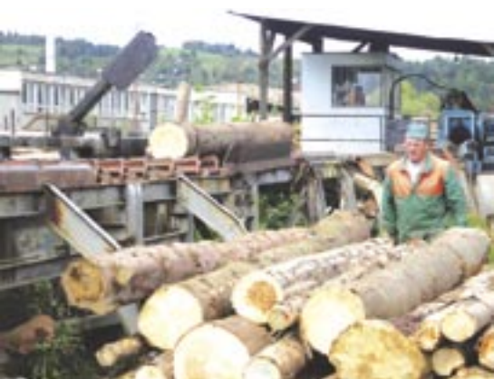
Manipulačná linka na ES Brezno z 80. roku viaže štyroch ľudí
