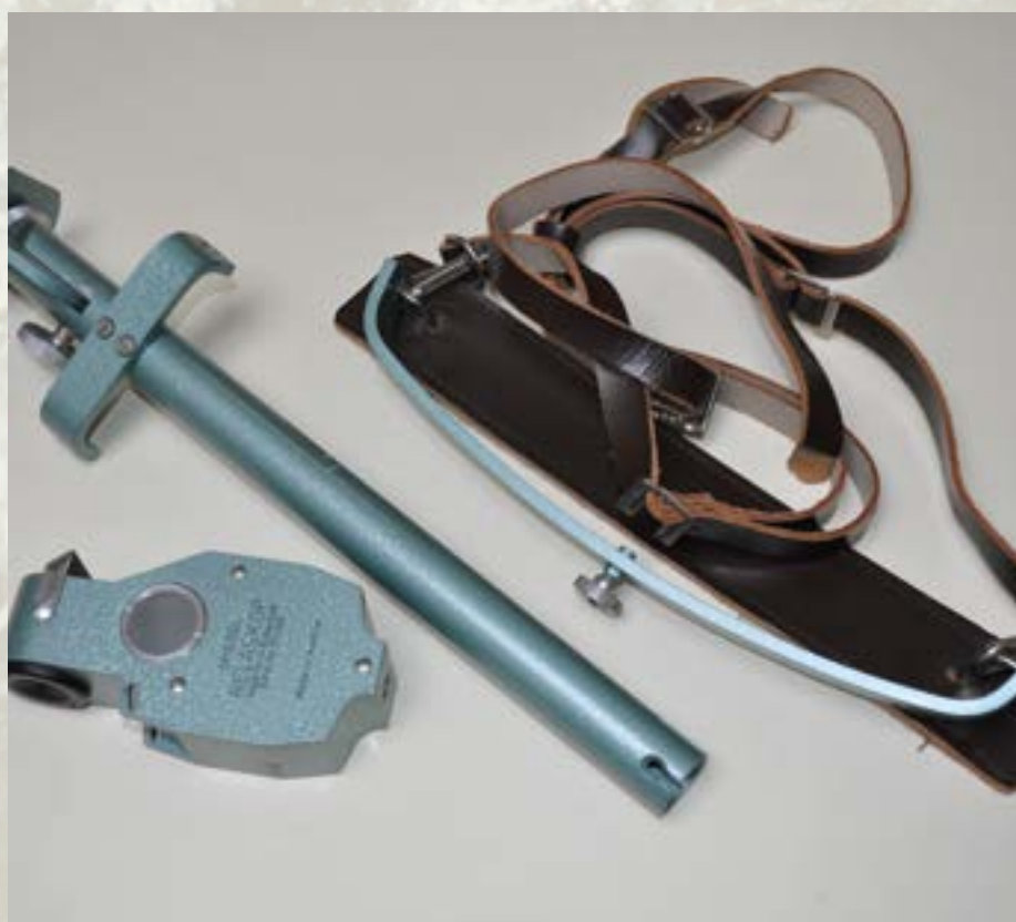
Zrkadlový relaskop so štandardnou škálou v koženom puzdre s popruhom na upnutie na telo z Lesoprojektu v Solivare
