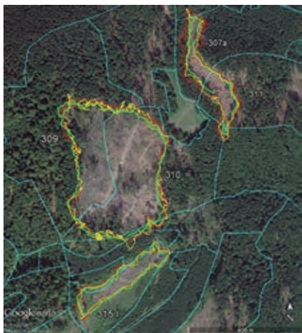
Obr. 1 Priebeg okrajov súvislých kalamitných plôch zameraných GNSS zariadeniami v lokalite Potoky (ZTE Blade, LG G2, Trimble Nomad 900)
